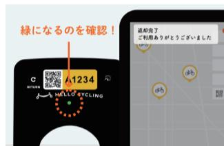
返却が完了すると、ピピッと2回ブザー音が鳴り、LEDランプが緑色に変わります。同時にアプリ内メッセージに返却完了の通知が送られます。
